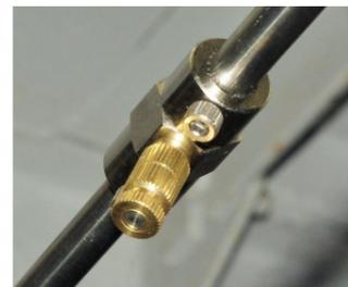
ステンレス管とスプレーノズル
