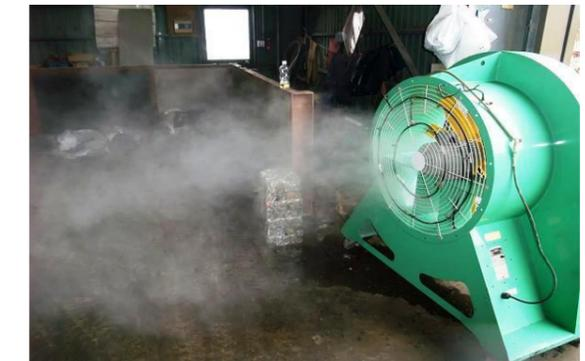
送風機に噴射ノズルを取り付けて
